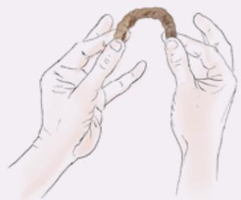
**Attention :** ne pas trop humecter le boudin car s'il est trop humide, une boue va se former et le test n'est plus réalisable.
